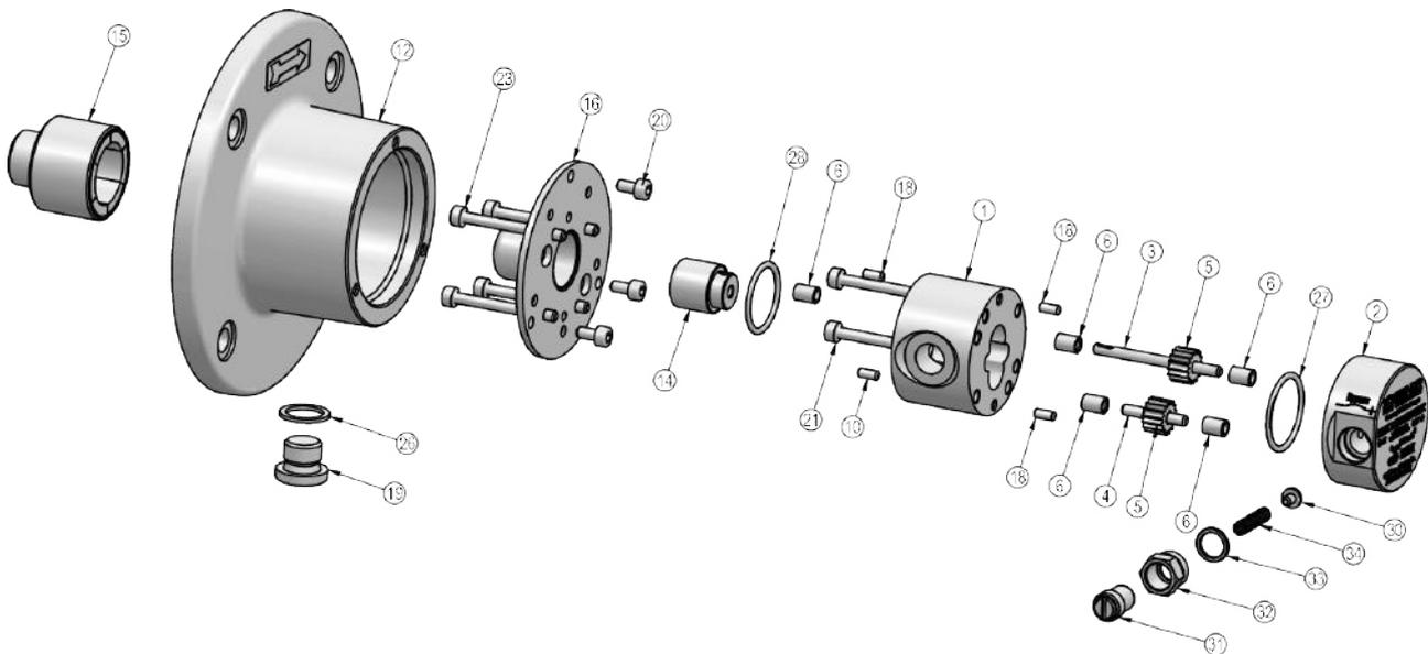
Abb. 4.2-1: Pumpenkörper
