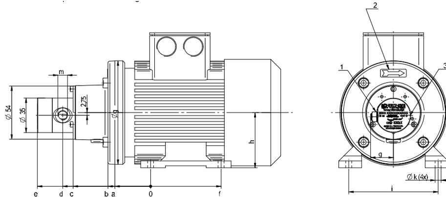
Abb. 2.1-1: Pumpenvariante mit Normgewinde (1: Sauganschluss, 2: Drehrichtung, 3: Druckanschluss)
