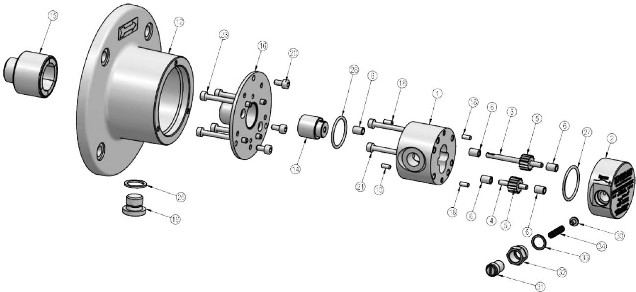
Abb. 7.4-1: Pumpenkörper
