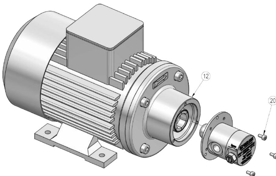
Abb. 6.7-1: Demontage Pumpenkopf
