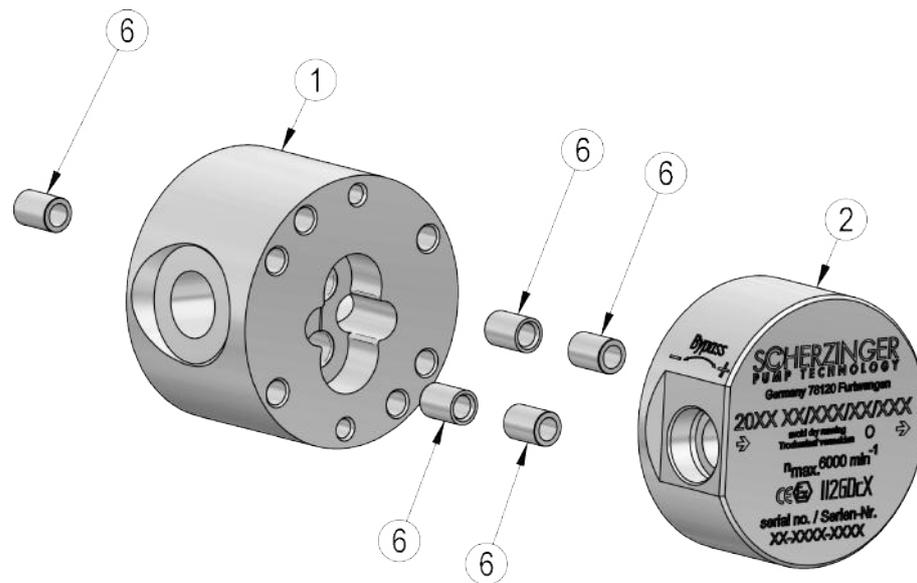
Abb. 7.4-3: Wellenlager
