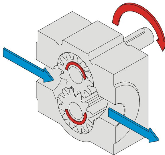
Abb. 4.1-1: Funktionsprinzip der Zahnradpumpe
