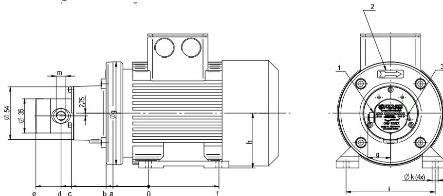
Abb. 10.1-1: Pumpenvariante mit Normgewinde (1: Sauganschluss, 2: Drehrichtung, 3: Druckanschluss)
